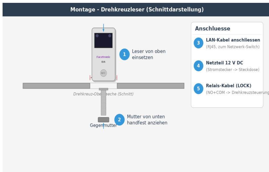
Abb. 4: Montage des Drehkreuzlesers
